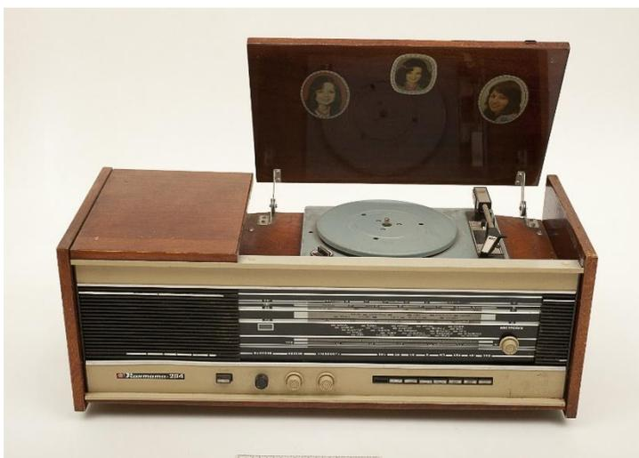
Радиола сетевая ламповая «Кантата-204» с 1976 года выпускалась Муромским заводом РИП.
